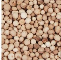
Водостойкий адсорбент SORBEO SGW представляет собой силикогель в виде шариков, которые имеют большие поры. Это буферный адсорбент, используемый для защиты верхнего слоя адсорбента. SGW поглощает большой объем воды в условиях высокой относительной влажности и, в частности, когда вода присутствует в жидкой фазе. Он также имеет высокий объем для поглощения жидких углеводородов и других органических жидкостей. Он используется в качестве буферного слоя в молекулярном сите и силикагеле.
