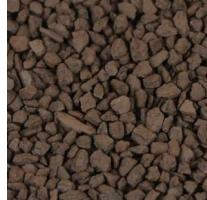
Катализатор SORBEO HC предназначен для катализитического окисления CO из CO<sub>2</sub> в сухом воздухе или других газах. Таким образом, ядовитый CO удаляется и вместо него образуется CO<sub>2</sub>. Этот процесс используется в таких приложениях, как сжатиедыхательного воздуха, респираторах, защитных масок и очистка криогенного газа.
