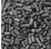
Гранулы из активированного угля могут очищать сжатый воздух и газы с помощью адсорбционного процесса и в основном используется для отделения паров масла от потоков сжатого воздуха. Активированный уголь можно использовать для других апликаций в соответствии со спецификой. Типичным использованием активированного угля является очистка природного газа, реформинг газа и воздуха.
