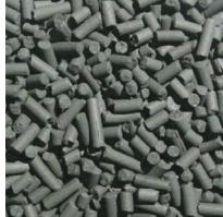
Sorbeo CMS представляет собой гранулированную форму молекулярного сита CMS в основном используется для отделения N<sub>2</sub> от воздуха, но также может использоваться в многих других условиях (выделение метана из метана / CO<sub>2</sub> или этилена из смеси этиленовых смесей ...). Типичным применением для активированного угля являются разделение Кислород / Азот.
