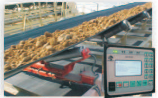
СИСТЕМА НЕПРЕРЫВНОГО ВЗВЕШИВАНИЯ / ВСТРОЕННАЯ В КОНВЕЕР CONTINUOUS WEIGHING/INTEGRATED ON BELT
