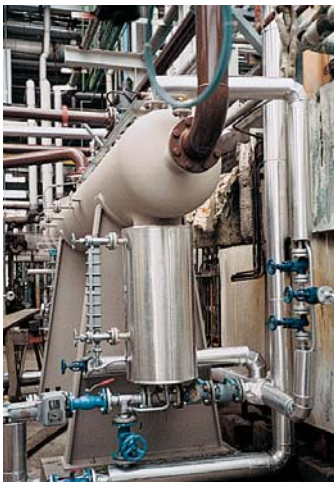
Горизонтальная система коалесцеров Фейзсеп Жидкости/Жидкость удаляет щёлочь из бензина.
