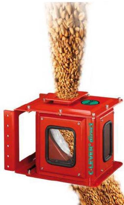
Имеющиеся аналоговые и цифровые выходы обеспечивают управление дозирующим устройством, связь с центром управления или персональным компьютером.
