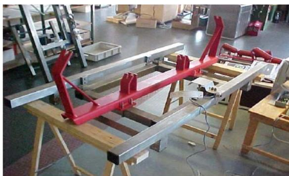
Рама с конструкцией для крепления роликов
